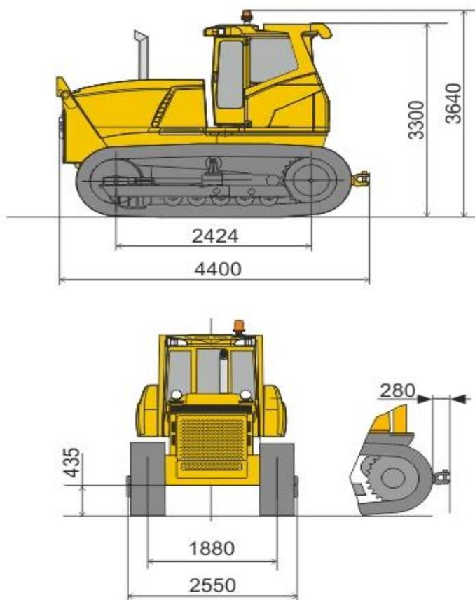
Дорожный просвет с непогруженными грунтозацепами, мм.....435±5
